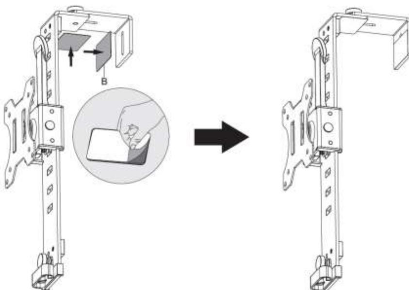
2. Une fois placé sur une cloison mobile standard, serrez le support en tournant le bouton dans le sens des aiguilles d'une montre jusqu'à ce que le support soit bien fixé.
