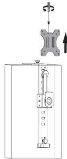
3. En utilisant un tournevis (non fourni), dévissez et retirez la plaque de fixation du support.
