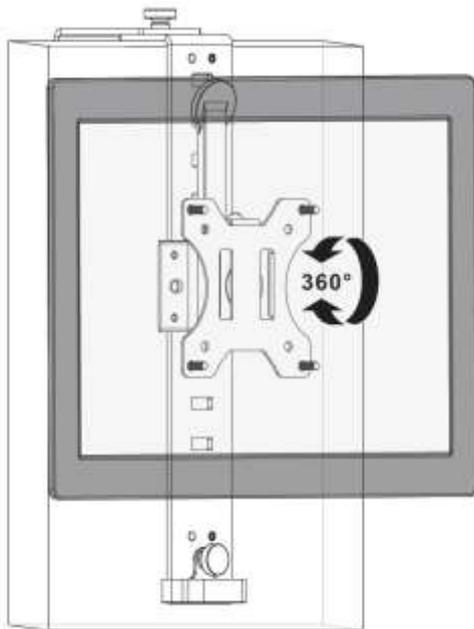
6. Für Hoch- oder Querformat kann die Befestigungsplatte um 360° gedreht werden.
