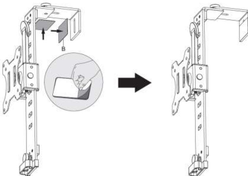
2. Una volta posizionato su un pannello separatore standard per open space, stringete il braccio di montaggio girando in senso orario il pomello fino a quando la staffa non sarà saldamente fissata.
