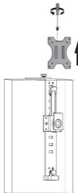
3. Utilizzate un cacciavite (non fornito) per svitare e rimuovere la piastra di fissaggio
