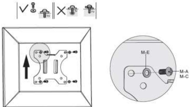
4b. Wenn das Display kürzere Schrauben erfordert (lesen Sie dazu bitte das Handbuch des Displays), befestigen Sie die Platte mit den gelieferten Schrauben (M-B) oder (M-D) am Display und verwenden einen Abstandshalter oder Unterlegscheiben auf beiden Seiten der Platte (siehe Diagramm rechts: M-E oder M-F).
