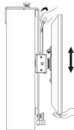
7. Um die Höhe des Displays einzustellen, ziehen Sie am verstellbaren Griff und schieben das Display vorsichtig nach oben oder unten zur gewünschten Höhe. Stellen Sie sicher, dass die Platte in ein Verriegelungsloch eingerastet ist, um sicheren Halt zu gewährleisten.
