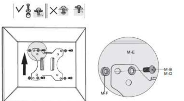
5. Una volta che la piastra è fermamente fissata allo schermo rimontatela sulla staffa. Quando spostate e fissate lo schermo vi preghiamo di operare in 2 persone.
