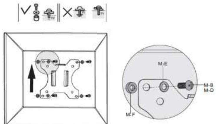
5. Wenn die Platte sicher am Display befestigt ist, schrauben Sie diese wieder an der Monitorhalterung fest. Führen Sie diese Arbeiten der Displaymontage zusammen mit zwei weiteren Personen durch.
