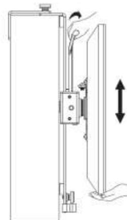
10. Pour ajuster la hauteur de l'écran, tirez sur la poignée et abaissez ou relevez l'écran avec précaution à la hauteur souhaitée. Assurez-vous que la plaque est bien enclenchée dans l'un des orifices de verrouillage pour une fixation sûre.
